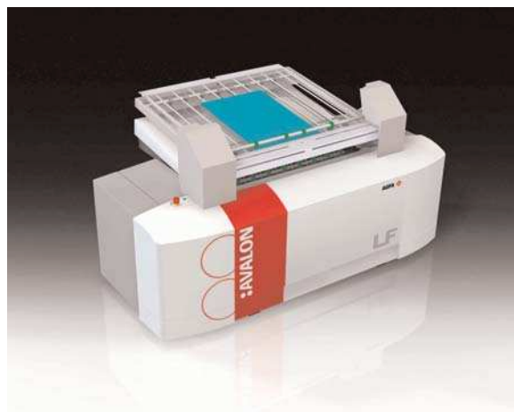
Figure 1 : Le CTP Avalon d'Agfa. La plaque est positionnée sur le plateau qui bascule vers l'avant et laisse la plaque s'enrouler autour du tambour. Le laser se positionne près de la plaque et se déplace vers la gauche. La vitesse de rotation du tambour est de 113 tours/minute
