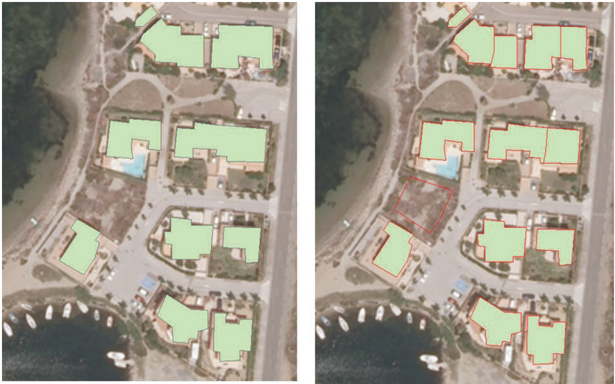
Figure 4 : Comparaison de la BD des bâtiments issus de la BD Topo IGN et de la BD des bâtiments, avec ajout et distinction des habitations après relevés de terrain
