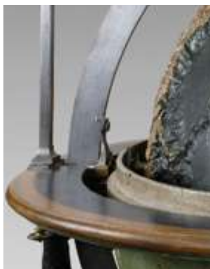
Figure 7 : Système de blocage du méridien à sa jonction avec l'axe des sphères. Cliché Bibliothèque nationale de France /DIP
