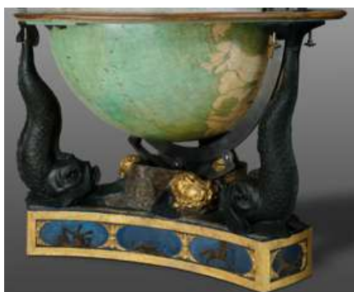
Figure 2 : Piètement du globe du Dauphin : base triangulaire, dauphins, coulisse et méridien, table d'horizon.
