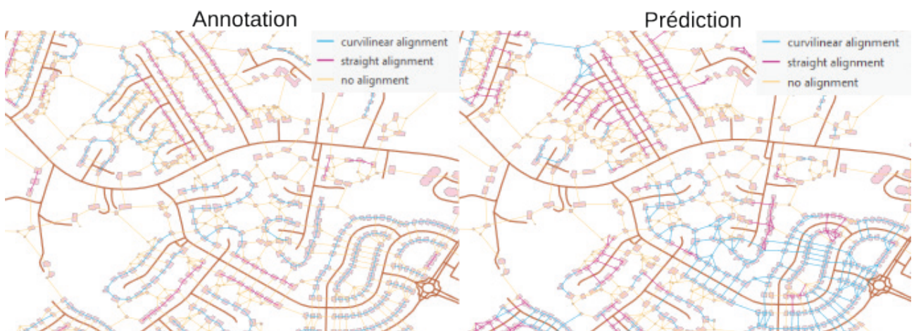
Figure 2 : Annotations (à gauche) et prédictions (à droite) pour la détection d'alignement par GCN.
